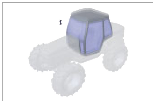
Fig. 6 Vibrations par sollicitation verticale de la cabine après optimisation
