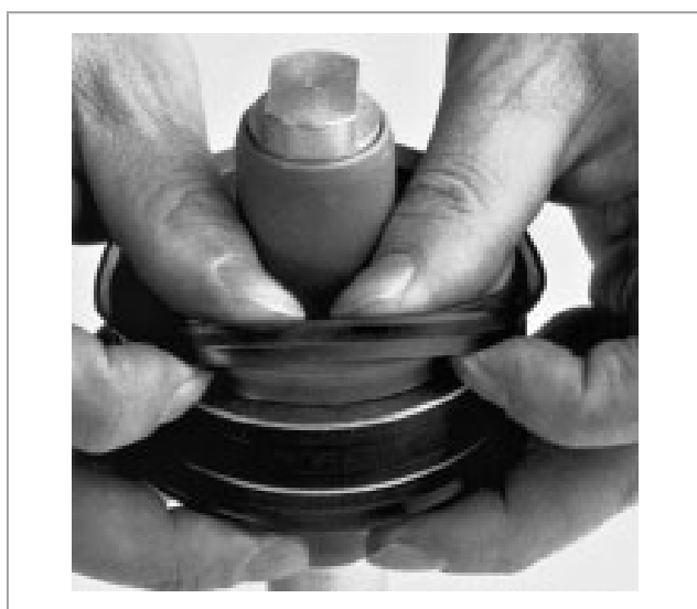
Fig. 26 Montage par déformation d'un joint de piston
