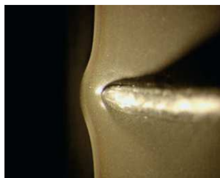
Lèvre d'étanchéité d'une bague Simmering après un cycle d'essai : dans un matériau FKM standard (ci-dessus, l'écartement à l'aide d'une spatule met en évidence la fissuration) et dans le matériau BRE 75 FKM 260507
