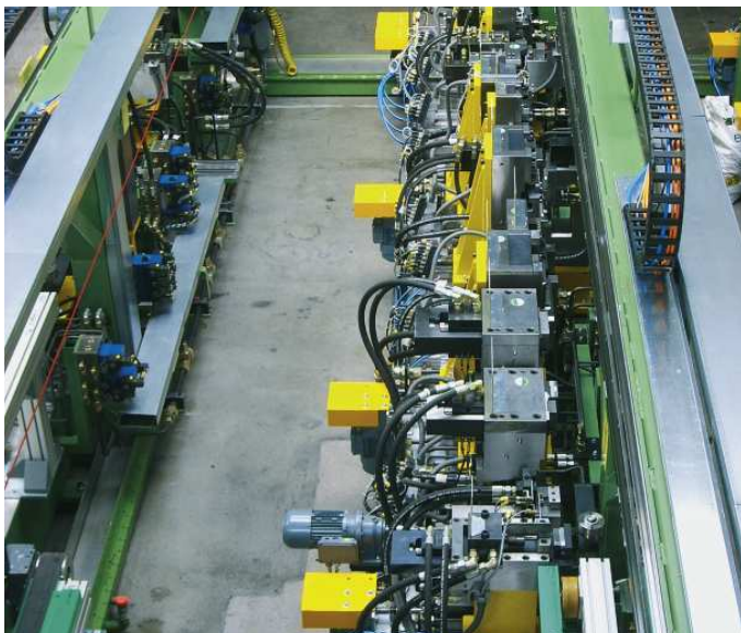
Production automatisée de dormants de porte avec des réducteurs ZAE.
